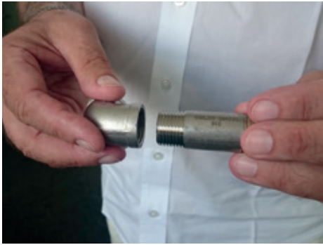
Rohr ablängen und Gewinde schneiden Couper le tube et fraiser le filetage Tagliare il tubo e svasare la filettatura
